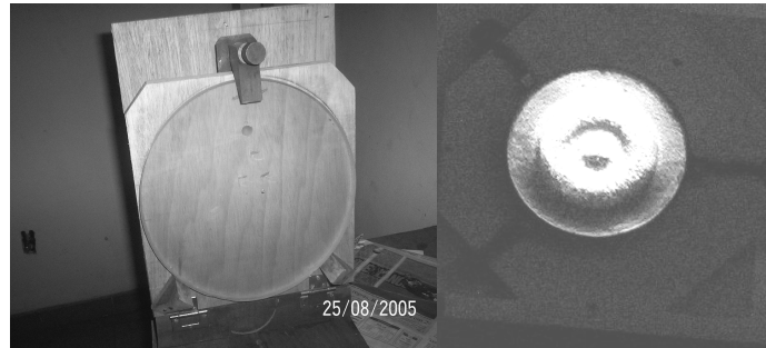
Figura 3- Esquerda: espelho primário sendo analisado; direita: superfície do espelho primário vista através do aparato de Foucault.
